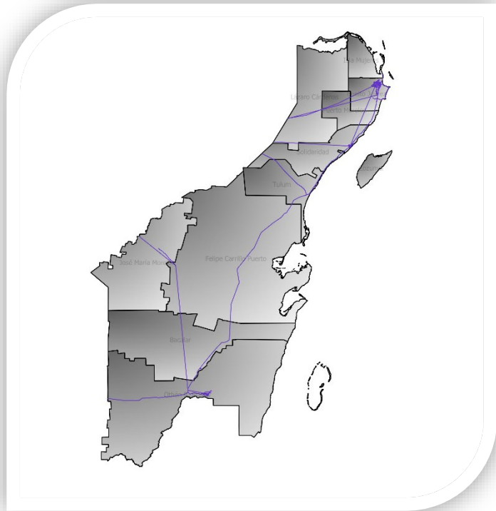
Mapa de red de transporte que se compone de los segmentos de agregación y distribución de fibra óptica a nivel municipal.
